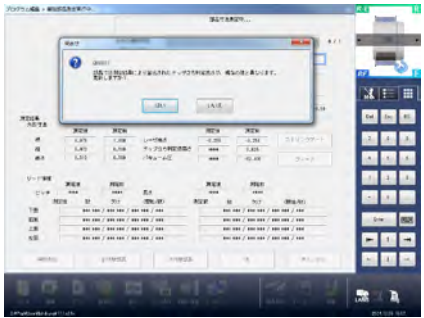
激光识别计测出实际尺寸，更新数值
